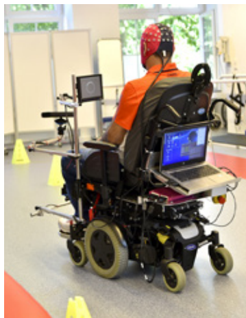
Patient mit Querschnittlähmung steuert den Rollstuhl mit seinen Gedanken.
